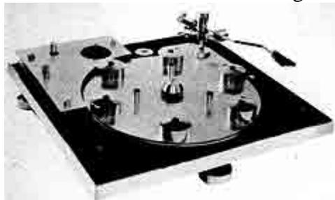
Der Transcriptor Hydraulik hatte zur Drehzahlstabilisierung eine Silikonöl-gefüllte Wanne unter dem Plattenteller, ein Paddel tauchte dort verstellbar tief ein und sorgte für gleichbleibende Abbremsung und Dämpfung, mit der dann die Drehzahl sich stabilisierte.
